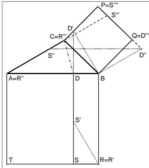
Nun unterwerfen wir in einer ersten Abbildung das Rechteck  $DBRS$  derjenigen Scherung mit Achse  $BR$ , die den Punkt  $D$  in den Punkt  $D'$  überführt. Da eine Scherung parallelentreu ist, ist das entstehende Viereck  $D'BRS'$  ein Parallelogramm, es hat bei  $D'$  und bei  $R$  Innenwinkel mit der Weite  $\alpha$ .
